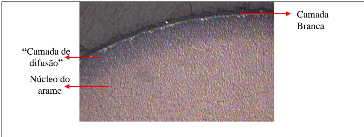
Figura 4 – Micrografia da superfície nitretada do arame, sem camada branca.
