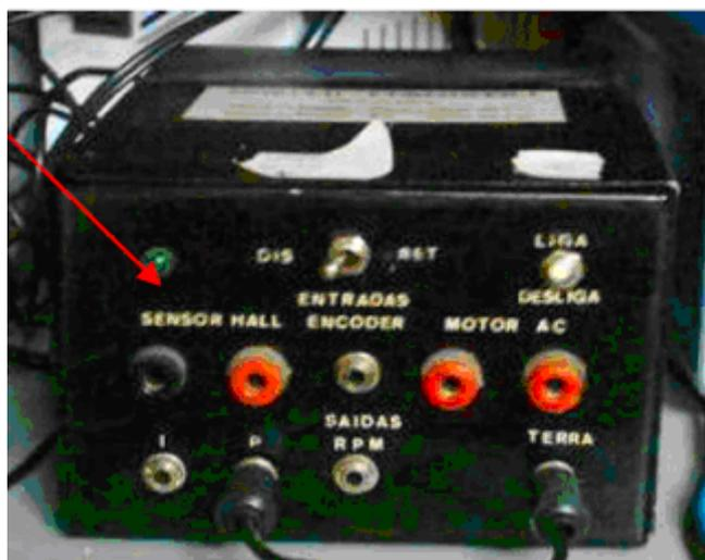
**Figura 31: Circuito eletrônico (CurvoPower) para aquisição da força tangencial de corte**
