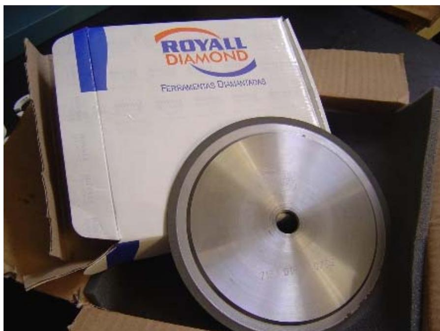
**Figura 38: Disco de corte diamantado utilizado para o corte das peças**
