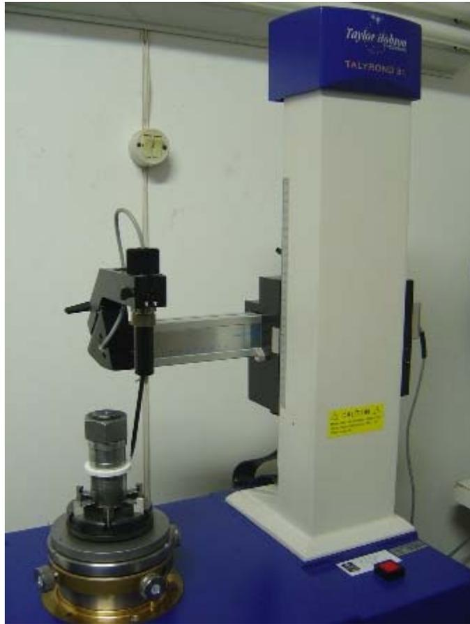
**Figura 33: Medidor de circularidade**
