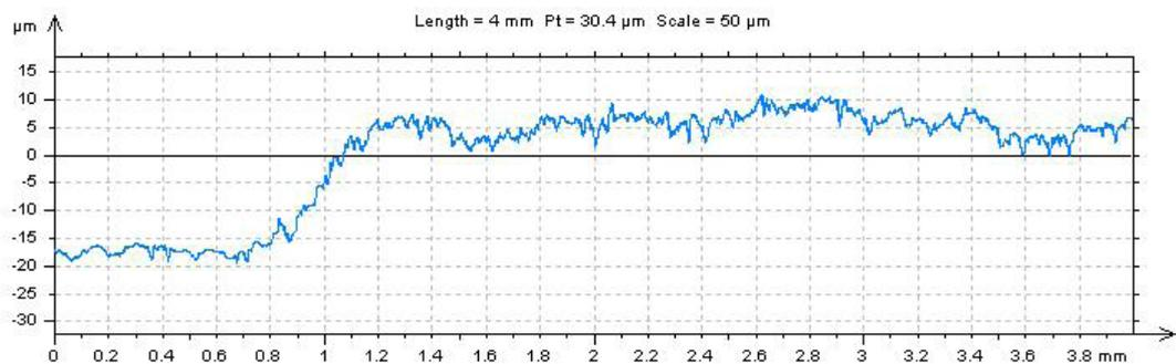
**Figura 40: Exemplo de gráfico obtido para a obtenção do desgaste diametral do rebolo**
