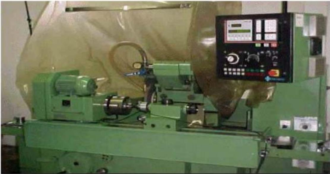
**Figura 16: Retificadora cilíndrica universal, CNC.**
