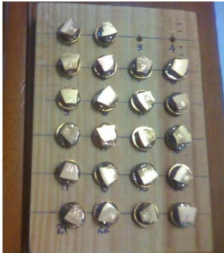
**Figura 41: Amostras preparadas para o MEV, com a deposição de ouro**
