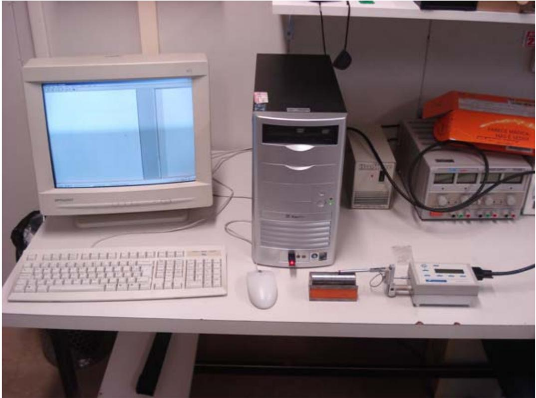
**Figura 37: Esquema da medição do desgaste do rebolo**
