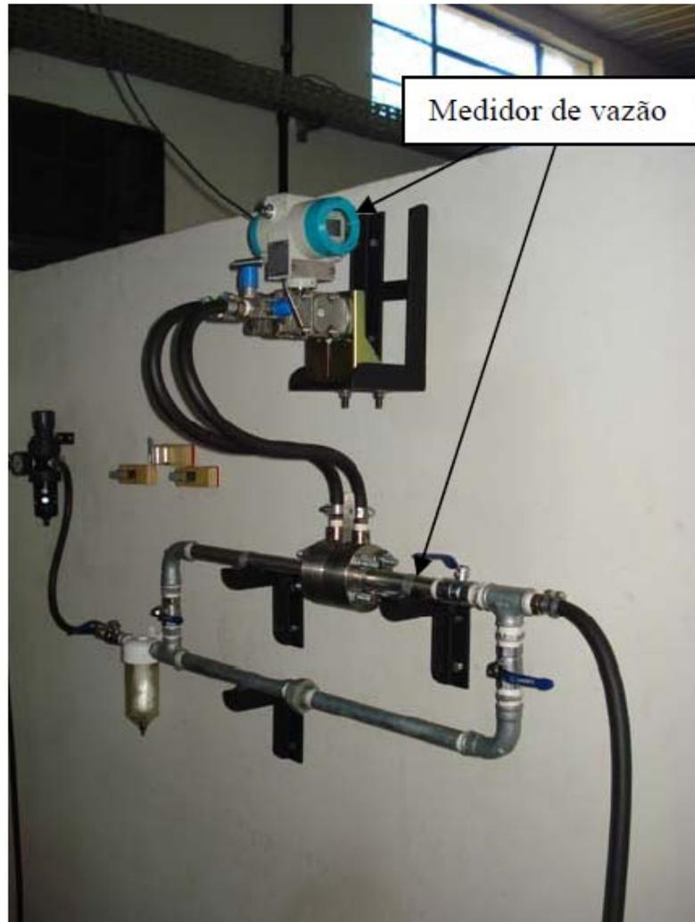
**Figura 24: Sistema de ar comprimido para a limpeza de rebolo**
