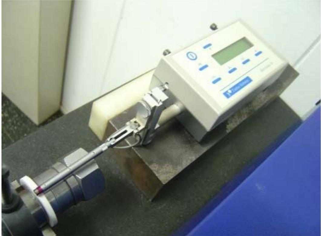
**Figura 35: Operação de medição de rugosidade**
