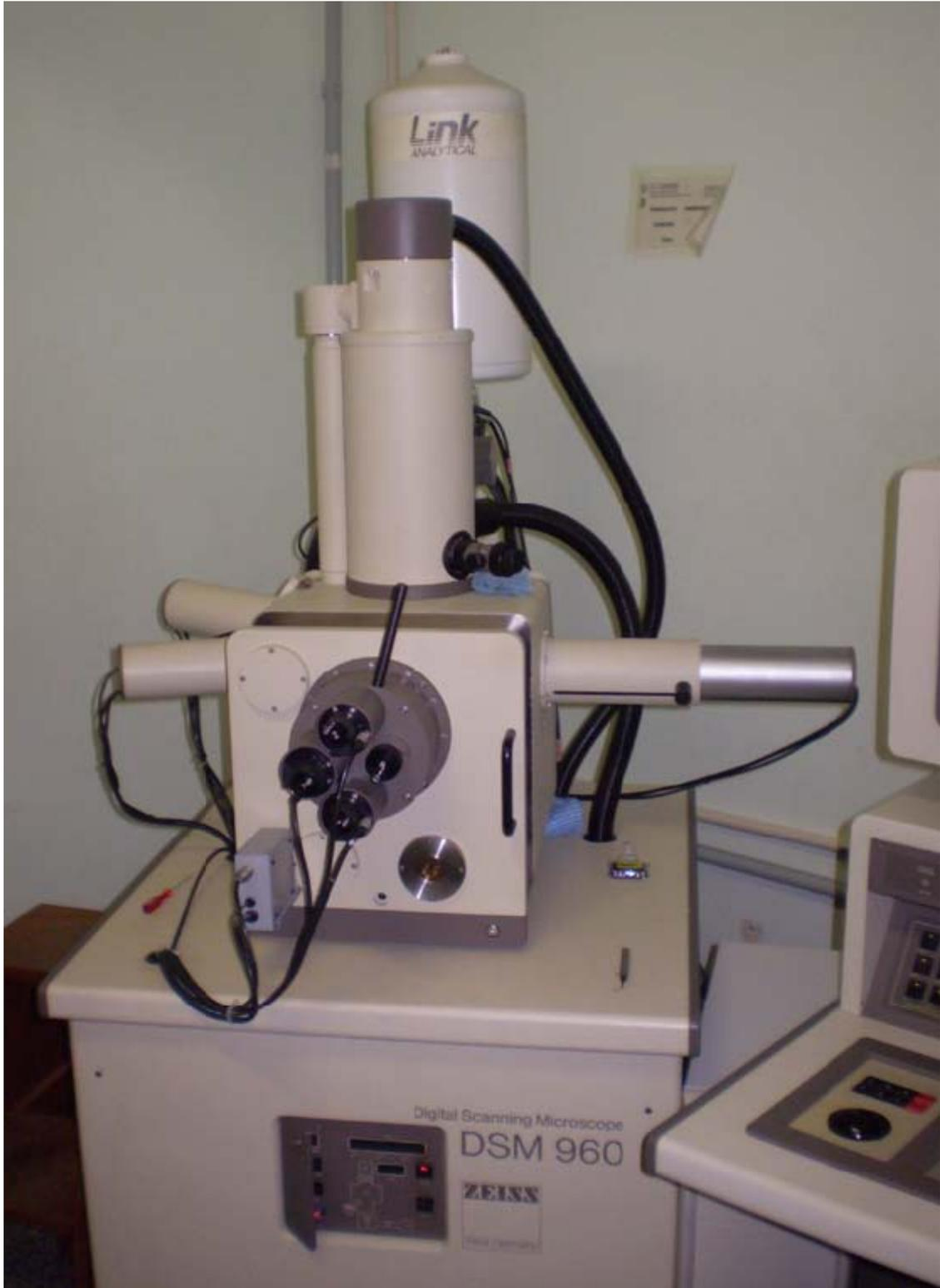
**Figura 43: Microscópio Eletrônico de Varredura utilizado**
