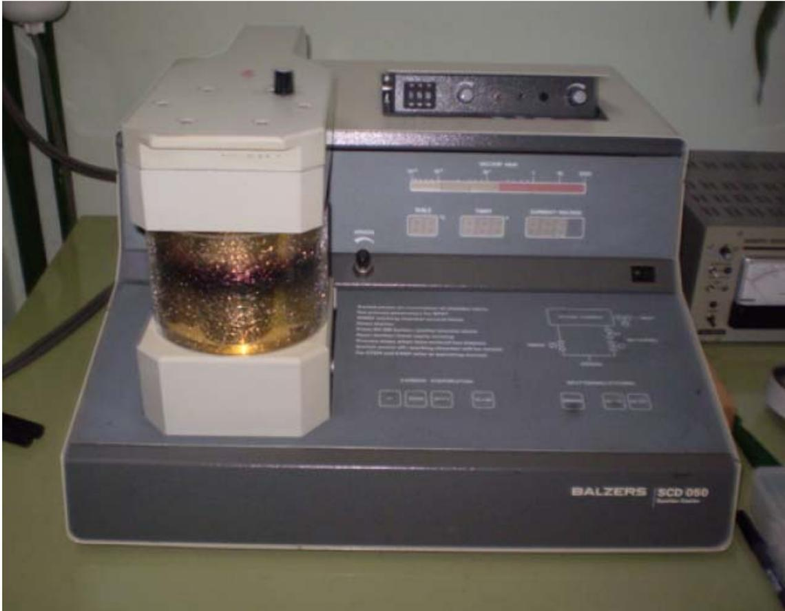
**Figura 42: Equipamento utilizado para deposição nanométrica de ouro nos corpos de prova**
