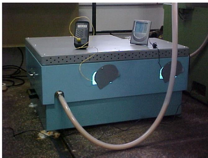
Figura 3: Vista lateral do reservatório e tampo com as janelas de observação e inspeção.
