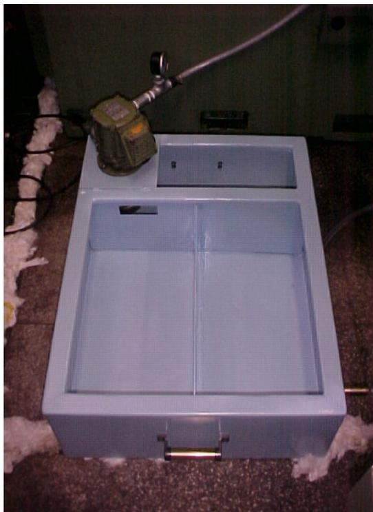
Figura 1: Vista superior do reservatório com seus três compartimentos e bomba de sucção.
