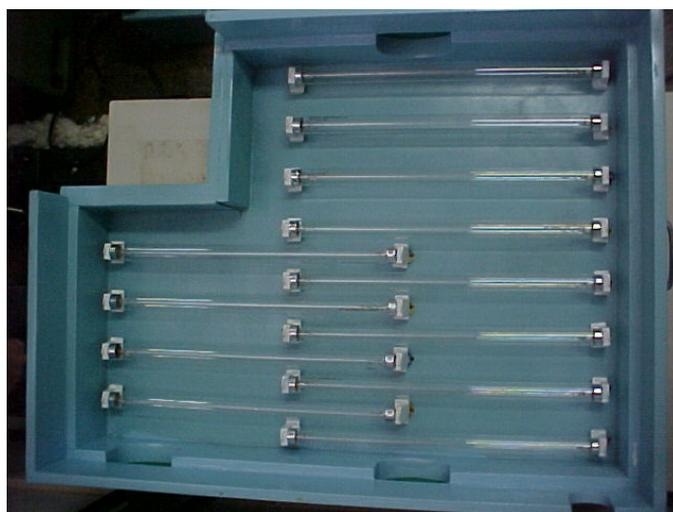
Figura 2: Vista interna do sistema emissor de radiação ultravioleta e a disposição das lâmpadas germicidas.
