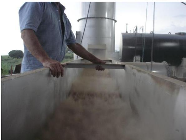
**Figura 25 – Resfriador aberto para demonstração da fluidização.**
