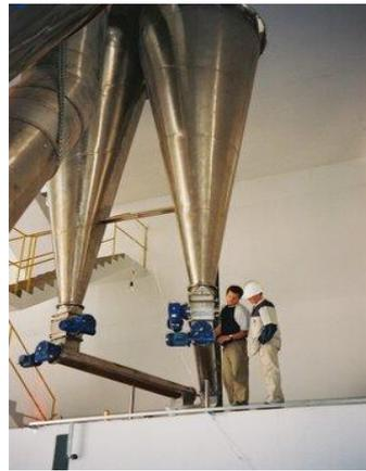
**Figura 17 - Coletor do spray dryer**
