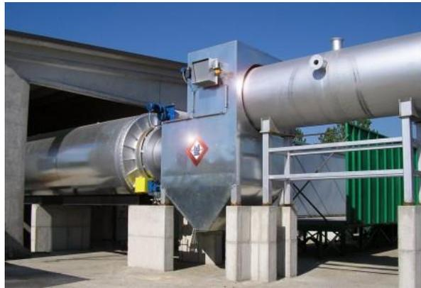
**Figura 12 – Secador rotativo**
