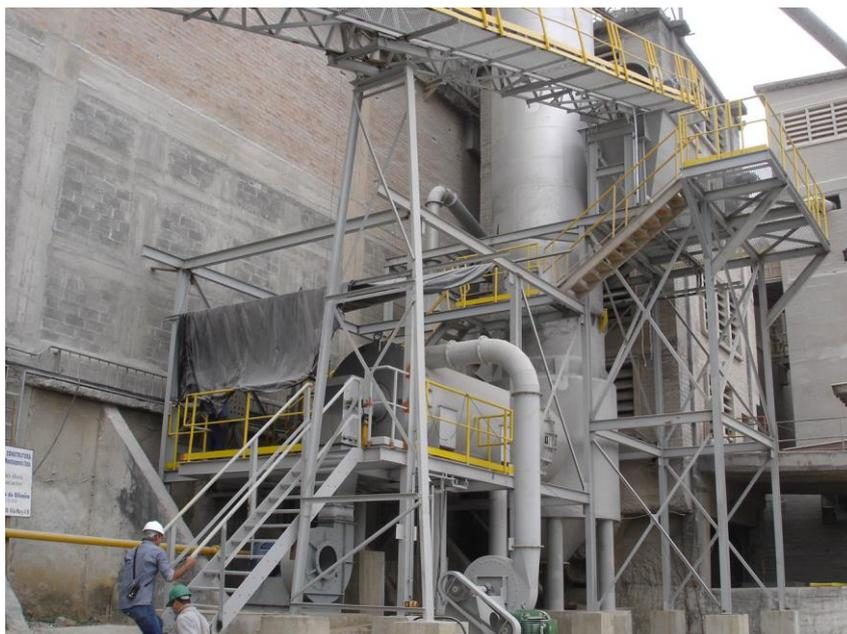
**Figura 26 - Unidade Secador Leito Fluidizado**
