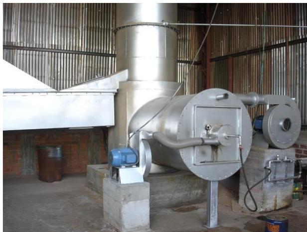
**Figura 24 – Secador com queimador simples a óleo**
