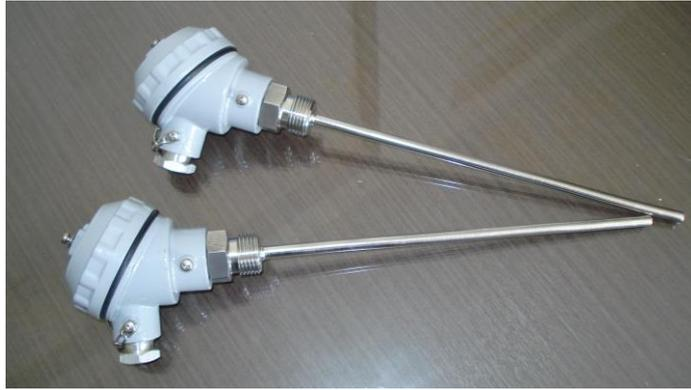
**Figura 30 – Termopar tipo K**
